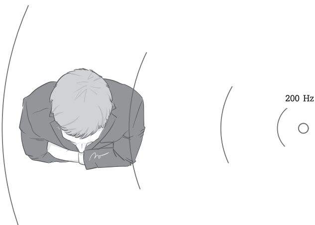
รูปที่ 2.39 ระบบประสาทส่วนกลางอาศัยข้อมูลระยะเวลาของคลื่นเสียงที่เดินทางมาตกกระทบหูสองข้างไม่พร้อมกัน โดยหลักของ interaural time difference เพื่อช่วยในการบอกทิศทางของเสียงที่มีความถี่ต่ำ ๆ ซึ่งคุณสมบัติสำคัญของคลื่นเสียงที่มีความถี่ต่ำ ๆ เหล่านี้ คือ การเลี้ยวเบน (diffraction) โดยคุณสมบัตินี้เกิดจากที่คลื่นเสียงความถี่ต่ำ ๆ โดยเฉพาะเสียงที่มีความยาวคลื่นมากกว่าขนาดของศีรษะ เมื่อเดินทางมาถึงศีรษะจะสามารถเดินทางอ้อมศีรษะไปได้โดยไม่ถูกบดบัง (วาดโดย วิสธรวัช แดงอ่อน หน่วยผลิตตำราคณะแพทยศาสตร์)
