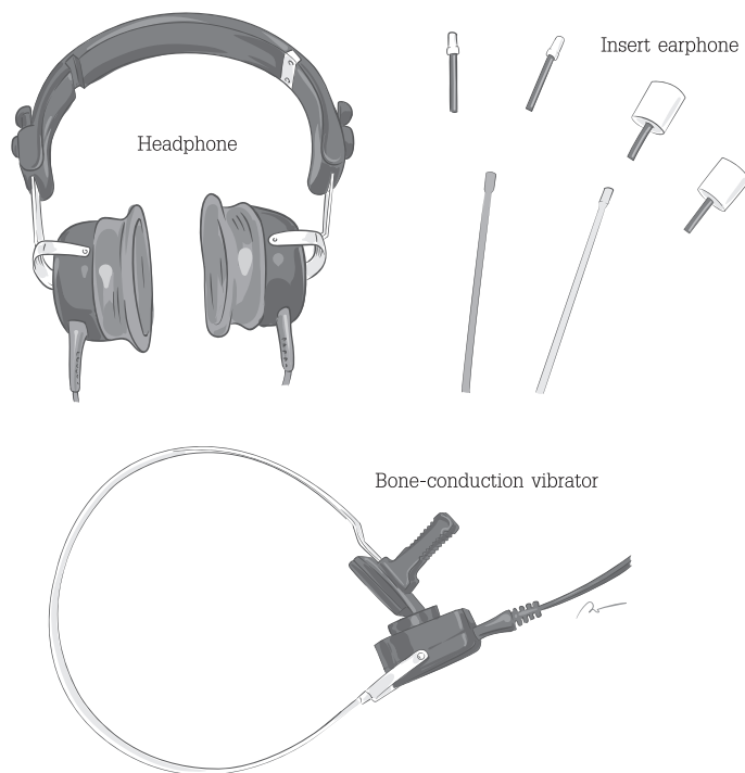
รูปที่ 3.9 | ตัวแปลงสัญญาณไฟฟ้าเป็นพลังงานเสียง (transducer) ได้แก่ headphone, insert earphone หรือ bone vibrator (วาดโดย วิสวัช แดงอ่อน หน่วยผลิตตำราคณะแพทยศาสตร์)
