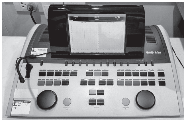
รูปที่ 4.2 | เครื่อง audiometer สำหรับตรวจการได้ยินเพื่อปล่อยเสียงกระตุ้นที่ระดับความดังและความถี่ต่าง ๆ
