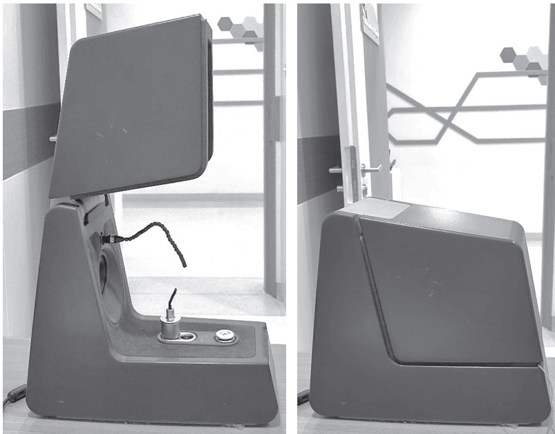
รูปที่ 6.20 | กล่องทดสอบ (test box) สำหรับใช้ตรวจวัดเสียงในการใส่เครื่องช่วยฟัง
