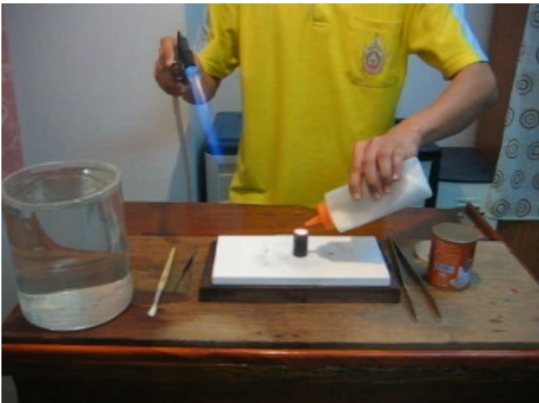
เมื่อก้อนโลหะเริ่มละลายกลายเป็นน้ำโลหะ ให้โรยผงน้ำประสานทองลงไปเล็กน้อยเพื่อช่วยในการหลอมละลาย
