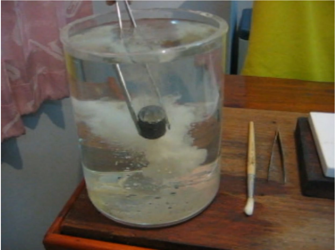
ใช้ปากคีบขนาดใหญ่คีบเข้าหล่อไปแช่ในน้ำเปล่า เพื่อละลายปูนหล่อออกจากเข้า
