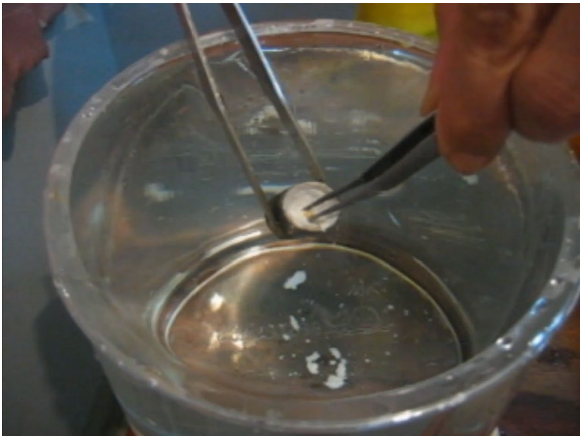
แช่เข้าหล่อไว้ในน้ำจนกระทั่งโลหะเย็นตัว จากนั้นใช้ปากคีบขนาดเล็กคีบชิ้นงานรูปพรรณที่ได้ออกจากเข้าหล่อ
