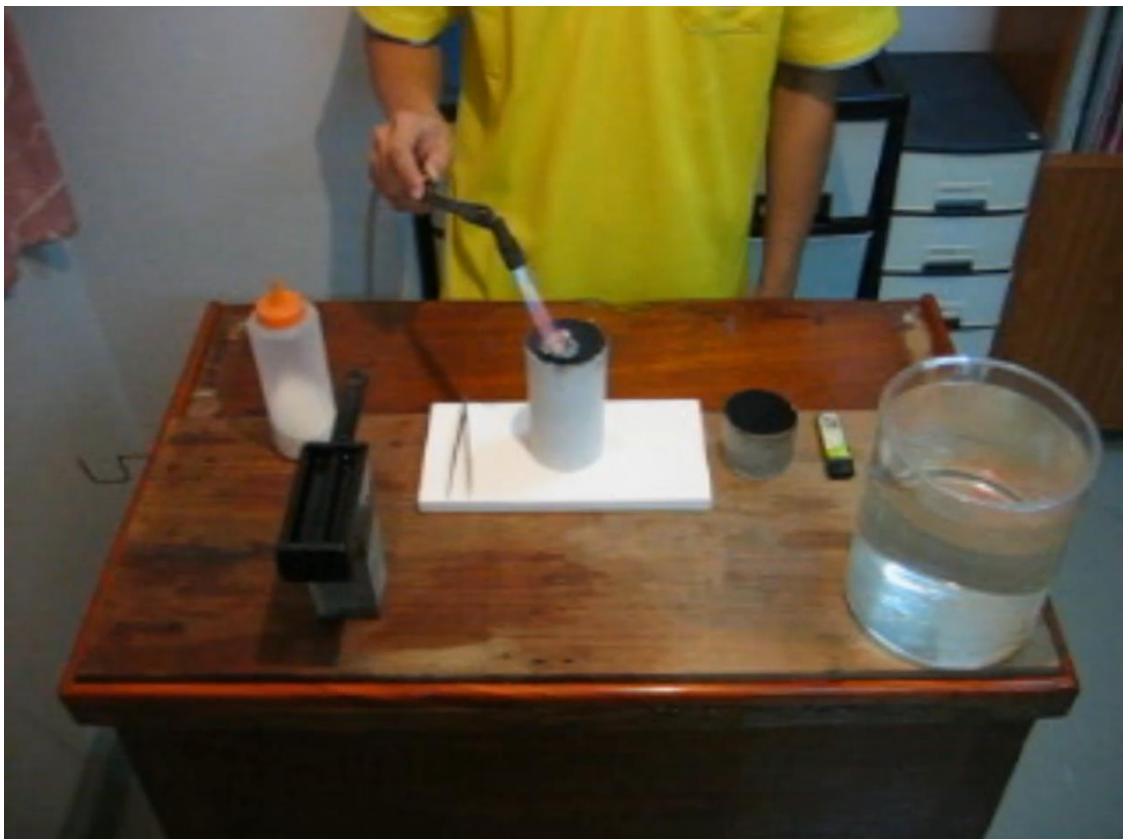
หลอมผงเงินเพื่อทำเป็นเงินแท่ง (ขั้นตอนและกระบวนการเหมือนการหลอมผงทองคำ)
