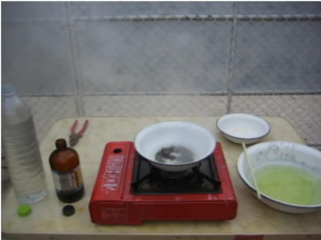
ทำกระบวนการตั้งแต่ต้มน้ำกรดถึงขยี้เกล็ดทองคำ ซ้ำอีก 2-3 ครั้ง
