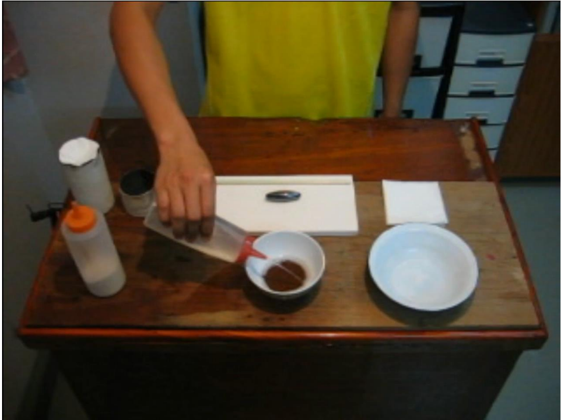
นำผงทองคำที่สกัดได้ใส่ถ้วยพลาสติกขนาดเล็ก เทน้ำเปล่าลงไปให้ท่วมผงทองคำ ประมาณ 1 ส่วน 3 ของถ้วยพลาสติก
