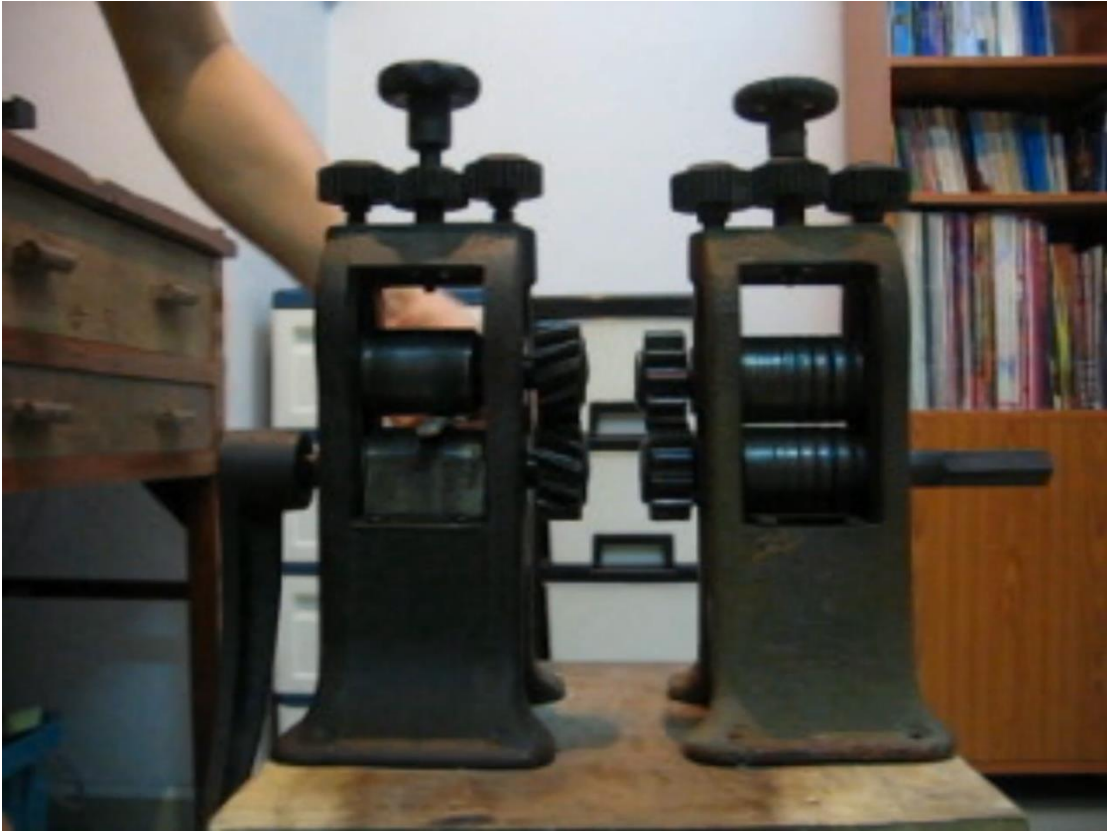
ใช้เครื่องรีดทองรีดแท่งโลหะผสมให้บางลง (หยอดน้ำมันจักรลงในลูกกลิ้งเครื่องรีดทองก่อนการใช้งาน เพื่อช่วยในการหล่อลื่น)
