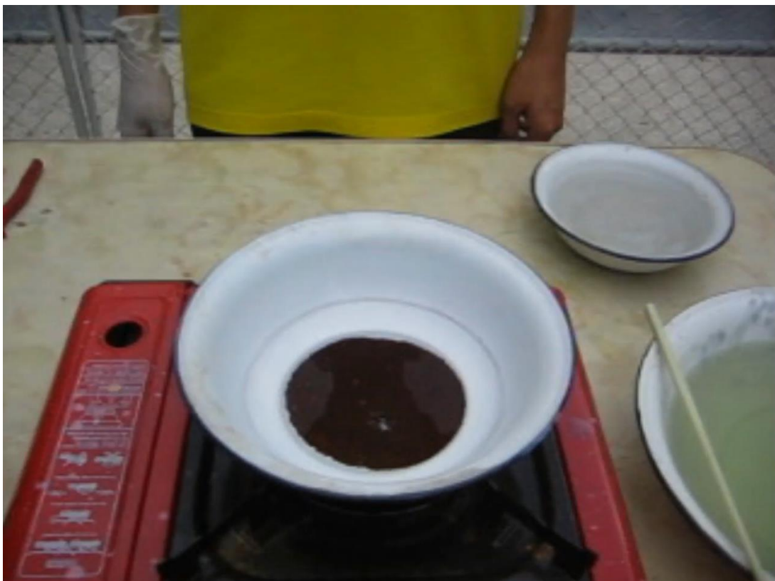
การต้มครั้งสุดท้ายให้สังเกตว่าน้ำกรดจะใสสะอาดและเหลือควันสีขาวเพียงเล็กน้อย
