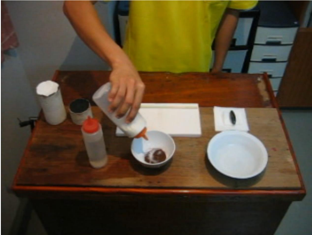
เทน้ำในถ้วยพลาสติกออกจนเกือบหมด โรยผงน้ำประสานทองลงไปผสมในผงทองคำ แล้วใช้ตะเกียบพลาสติกคนให้ทั่ว
