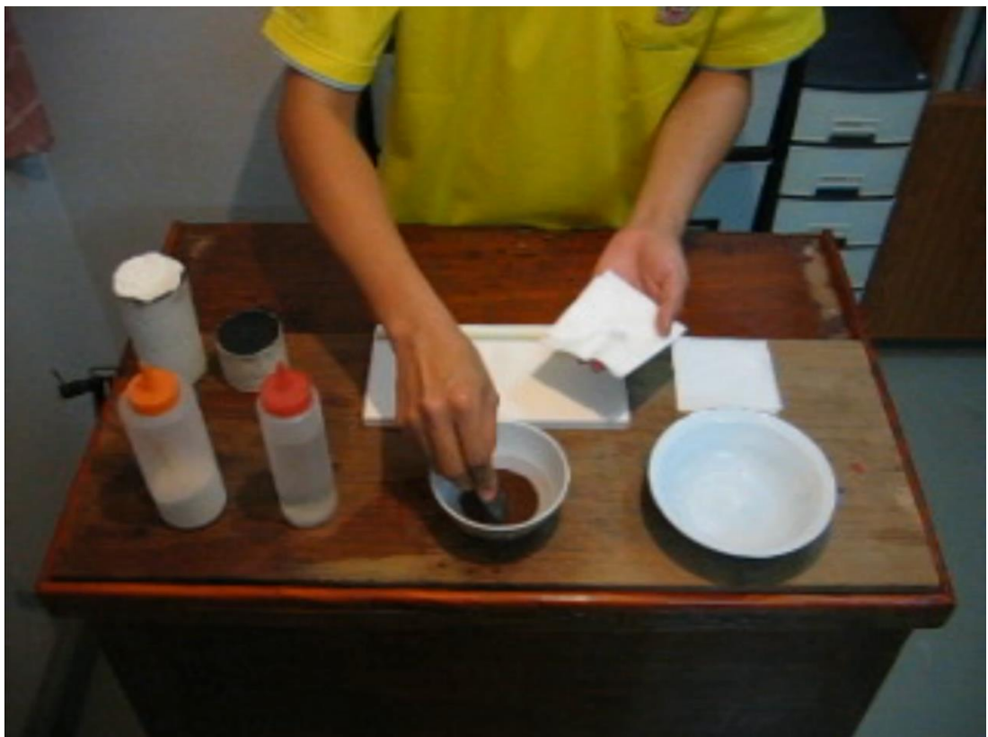
ใช้แม่เหล็กดูดเศษเหล็กที่อาจปนเปื้อนในผงทองคำออกให้หมด ทำความสะอาดแม่เหล็กด้วยกระดาษชำระ
