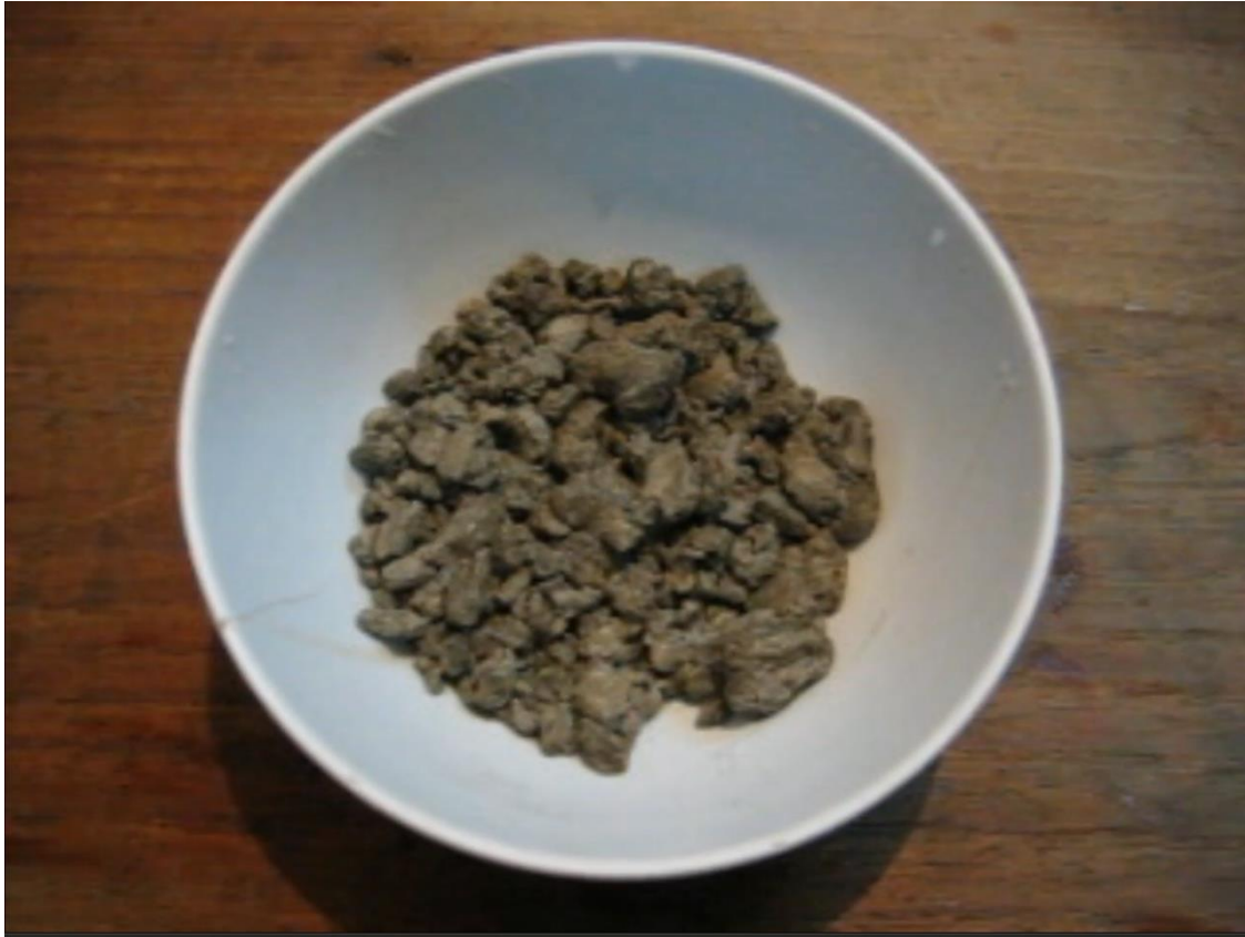
เทน้ำกรดออกให้หมดแล้วใช้น้ำเปล่าล้างผงเงินให้สะอาด
