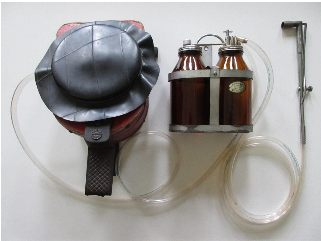
ชุดหลอมทอง ประกอบด้วย ที่สูบลม (คาต๊ะ) + ขวดน้ำมัน + หัวเป่าไฟ + สายยางใส จำนวน 1 ชุด
