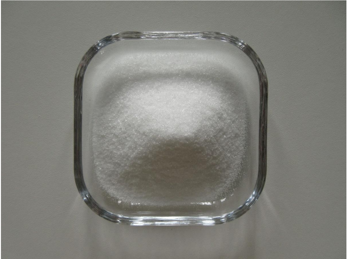
เกลือโซเดียมโบเรต (Sodium Borate) หรือผงน้ำประสานทอง หรือผงบอแร็กซ์ (สูตรเคมี \text{Na}_2[\text{B}_4\text{O}_5(\text{OH})_4] \cdot 8\text{H}_2\text{O} ) จำนวน 100 กรัม
