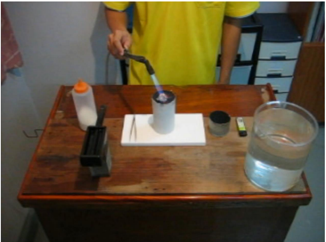
ใช้หัวเป่าไฟเผาผงทองคำในห่อกระดาษชำระ จนกระทั่งละลายกลายเป็นของเหลว
