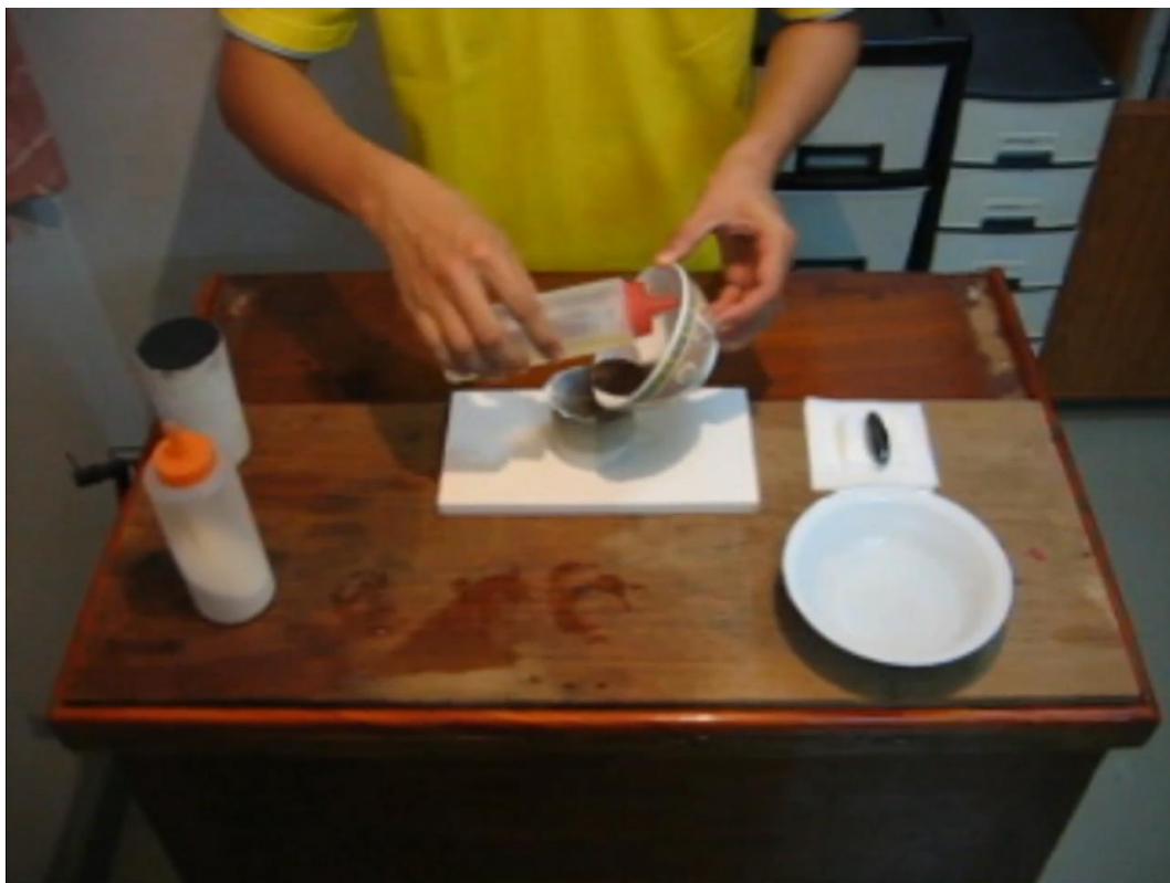
นำกระดาษชำระ 1 แผ่น มารองไว้ที่ปากเบ้าหลอม เทผงทองคำจากถ้วยพลาสติกลงบนกระดาษชำระแผ่นดังกล่าว ใช้น้ำเปล่าเทเพื่อช่วยให้ผงทองคำไหลออกจากถ้วย แล้วโรยผงน้ำประสานทองลงบนผงทองคำ
