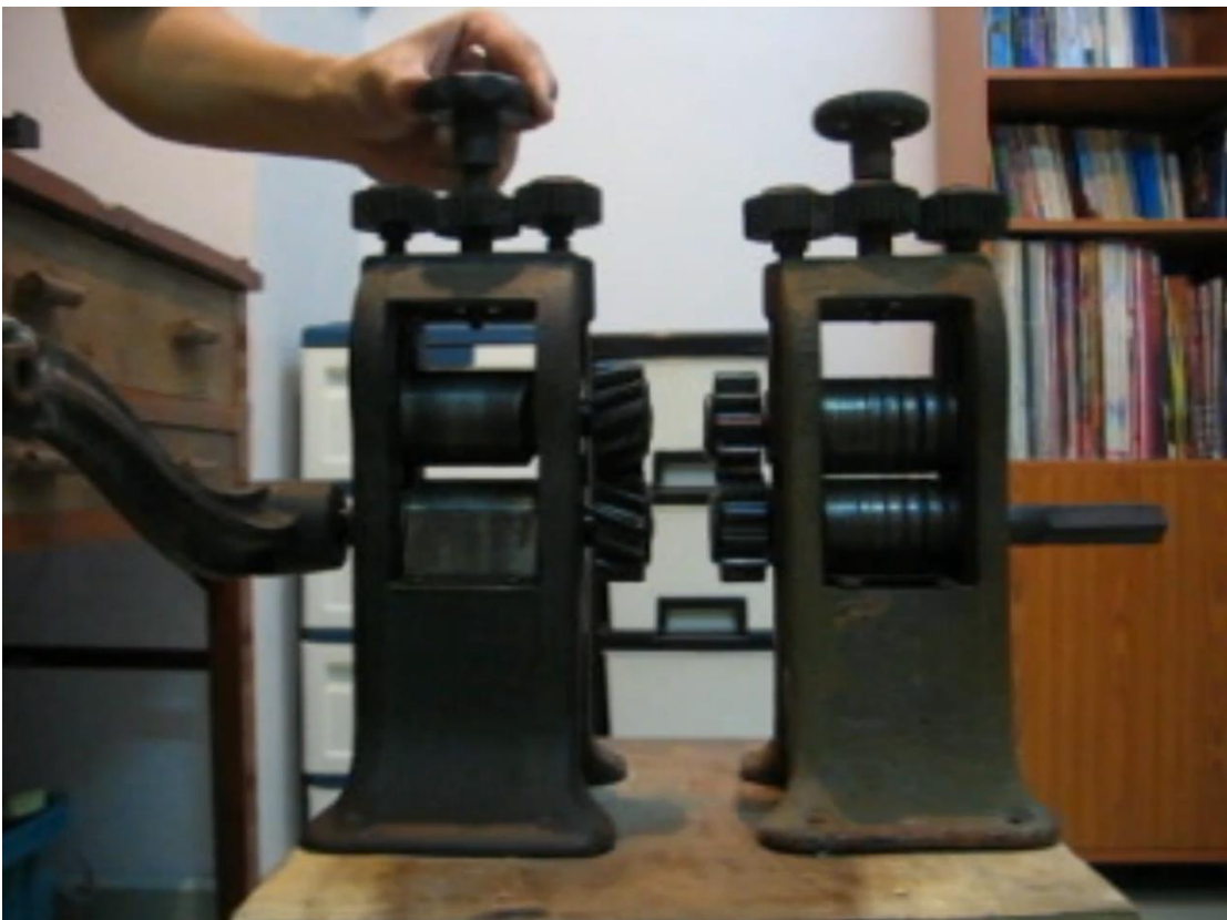
ปรับระดับความห่างของลูกกลิ้งเครื่องรีดทองลงเป็นระยะ ตามความหนาของแผ่นโลหะ เครื่องรีดทองจะกดอัดทำให้แท่งโลหะค่อย ๆ บางลงเป็นแผ่น และมีความยาวเพิ่มขึ้นเรื่อย ๆ
