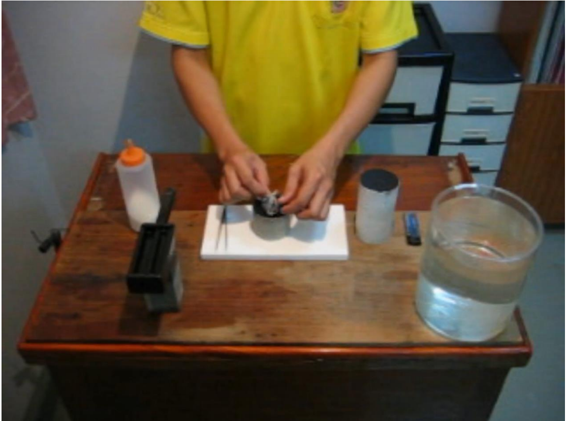
เมื่อน้ำซึมลงในเบ้าหลอมหมดแล้ว ให้ห่อกระดาษชำระกับผงทองคำ แล้วยกขึ้นนำไปใส่ในเบ้าหลอมอีกใบหนึ่ง
