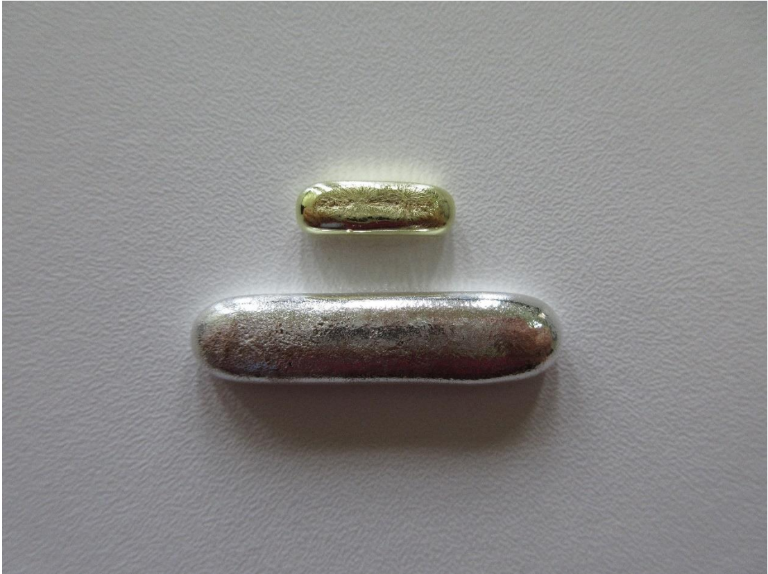
นำโลหะทองคำ 1 ส่วน และโลหะเงิน 3 ส่วนที่ได้ มาเตรียมหลอมเพื่อผสมให้เป็นเนื้อเดียวกัน
